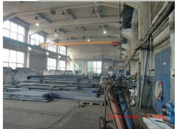
Jedná se o jednopodlažní halu s jeřábovou dráhou (mostový jeřáb o nosnosti 5t - nefunkční, mostový jeřáb o nosnosti 10t - ve vlastnictví nájemce) ze železobetonového skeletového systému s
